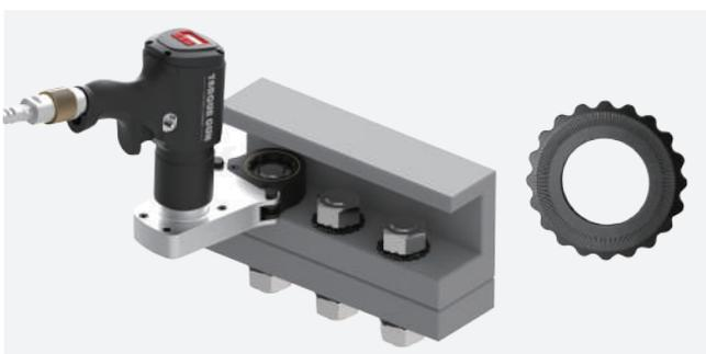
ハイトルクワッシャーシステムにより反力受けが不要になります。反力受けはボルト締結作業において怪我の最も一般的な原因です。ハイトルクオフセットリンクはハイトルクワッシャーをご使用いただけます。
