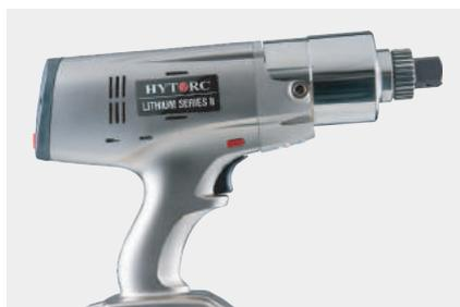
ニッケルメッキ処理を施したアルミ製ハウジングを使用することで耐食性や全体的な耐久性が大きく向上しました。36Vのブラシレスモーターは、従来のものに比べ5倍ほど長持ちします。ギアボックスは強度と信頼性が20%向上するように再設計されています。内蔵の背面カバーの衝撃ガードはディスプレイとボタンを保護し衝撃を和らげます。
