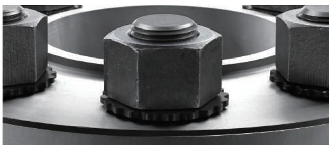
HYTORCWasherによって、ボルテイング作業中に怪我をするおもな原因となる反力アームの必要がなくなりました。ワッシャーの独特なデザインは、ナットを回すために反力を二層安全ソケットで取る構造になっています。
