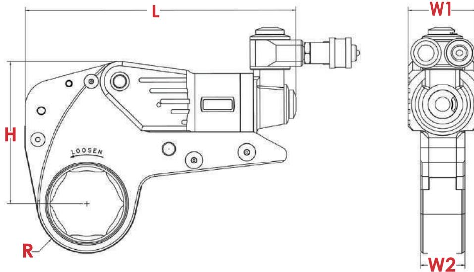
H=高さ W1=工具本体の幅 W2=リンクの幅 L=長さ R=半径
